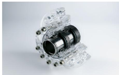
Dans la centrale nucléaire finlandaise d'Olkiluoto (bloc 3), une pompe d'alimentation à haute pression CVCS qui fait circuler de l'eau radioactive doit être absolument fiable. Une garniture mécanique **SHFV-D4-/77-E1-Q** est utilisée dans cette application. Conditions de service :  $p = 181 \text{ bar}$ ;  $t = 15 \text{ à } 100 \text{ °C}$ ;  $n = 2980 \text{ min}^{-1}$ .
