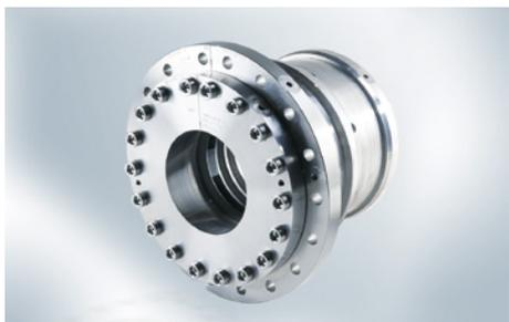
Sur une vanne qui ferme les clapets d'isolation en cas d'urgence dans la centrale d'Olkiluoto (bloc 3), en Finlande, une bague carbone flottante Espey à purge de fuite **WKA600S** est utilisée pour isoler la vapeur. Conditions de service :  $p = 11,6 \text{ bar}$ ;  $t = 311 \text{ °C}$ .
