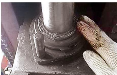
Sur la centrale à charbon PT.Ipmomi, en Indonésie, un souffleur de suie traitant des gaz d'échappement à haute température qui contiennent des cendres volantes et de la vapeur doit être étanché. Des tresses **Isartherm 6011A** et **Isartherm-Flex 6050** contribuent à assurer un fonctionnement sûr et fiable. Conditions de service :  $p = 40 \text{ bar}$ ;  $t = 400 \text{ °C}$ .
