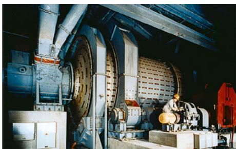
Dans la centrale Power Development Co. Ltd. de Dezhou Shandong Huaneng, en Chine, un dispositif d'étanchéité est utilisé pour contenir l'air d'évacuation chaud chargé de poussière de charbon dans le col d'un broyeur de charbon. La solution idéale : un joint **Espey WD200/500**. Conditions de service :  $p = 1,08$  bar;  $t = 110$  °C;  $n = 15,8$  min<sup>-1</sup>.
